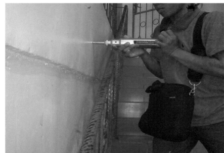
Gambar 5. Dokumentasi Hammer Test Balok
