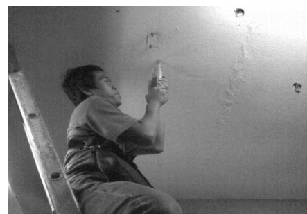
Gambar 5. Dokumentasi Hammer Test Balok
